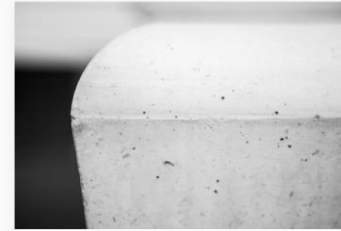
Vibers inside Beton Beton voor de openbare ruimte Slecht 1% Vibers vezels levert een reductie van de carbon footprint op tot 35%.
