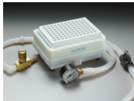
Merck/Millipore Filtratieplaat MSHAN4510; 96-wells plaat met 0.45 µm porie-grootte; Mixed Cellulose Esters membraan op een Millipore Vacuum Manifold
